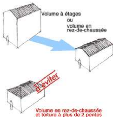
Toit à 2 pentes
