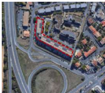
Exemple d'un bâtiment « écran » conçu pour minimiser les nuisances sonores sur les bâtiments situés en deuxième rang - Source : Google Maps
