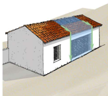
Illustration de la prise en compte des éléments d'architecture (ouvertures, ici) pour l'implantation des panneaux solaires à la toiture - Source : UDAP 17
